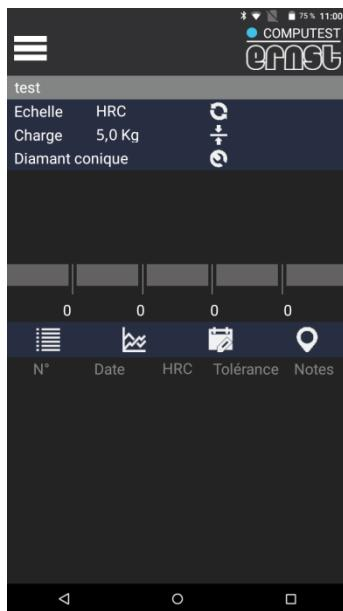
Après avoir préparé la surface d'essai, placer le duromètre e-Computest sur la pièce à mesurer.
