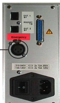
Connexion du bouton d'arrêt d'urgence
