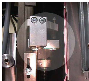
Vue de l'écrou d'entraînement non assuré dans le bloc de déplacement de l'axe Z
