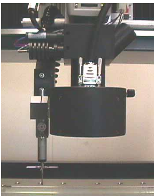
Le système Combo (système palpeur à côté du système optique)
