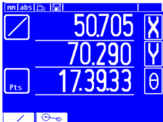
Ecran des résultats après mesure d'une droite
