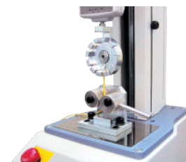
Configuration GP30 + FW12 sur banc d'essais vertical
