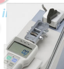
Configuration CW-500N + CH-500N sur banc d'essais horizontal
