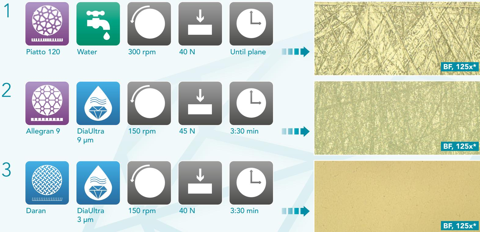
Les temps sont indiqués pour un système de préparation de 300 mm et les forces pour un échantillon individuel de 40 mm de diamètre.
