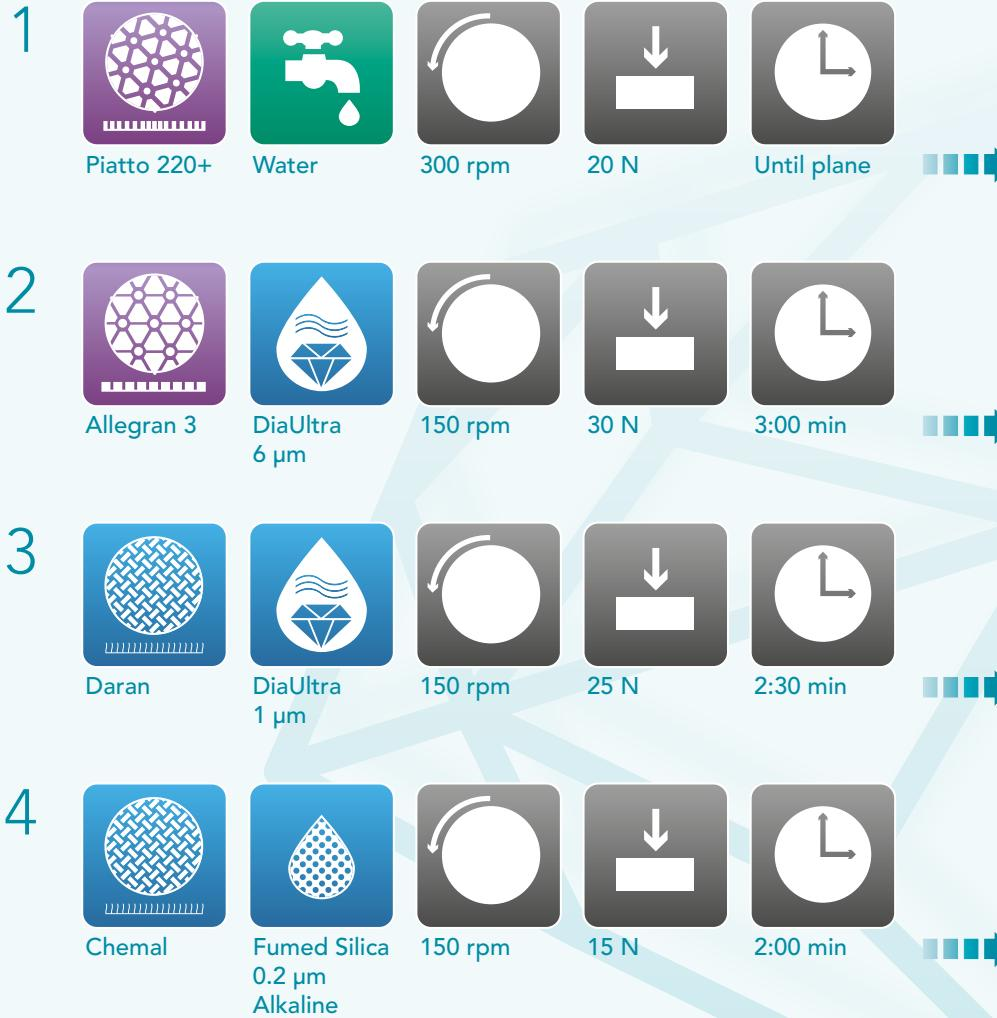
Les temps sont indiqués pour un système de préparation de 300 mm et les forces pour un échantillon individuel de 40 mm de diamètre.
