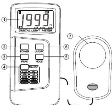
1. affichage LCD : 3 ½ chiffres avec une lecture maximale jusqu'à 1999.
