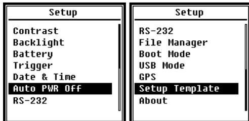
Le menu de **configuration** contient les fonctions de base de configuration et d'affichage des conditions. Utilisez les touches fléchées **<▲>**, **<▼>** pour **sélectionner** l'option et appuyez sur **<Enter>** pour passer au **niveau de** menu suivant.
