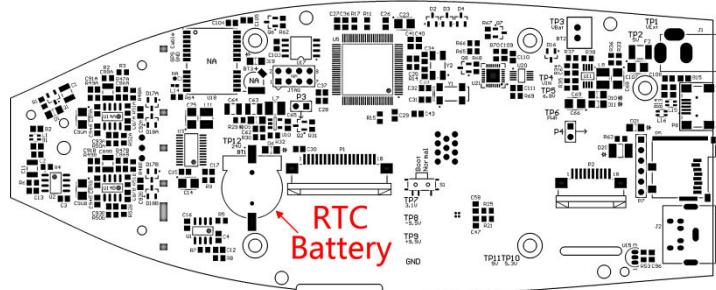
**☆Note :** L'horloge système du sonomètre a été étalonnée avec une horloge de référence avec une erreur moyenne de 2 ppm (erreur maximale de 3 ppm). La précision du temps est inférieure à 10 ppm à température ambiante (<26 secondes en 30 jours). L'erreur maximale de temps était d'environ 5 à 8 secondes pendant les essais internes à 25 °C.
