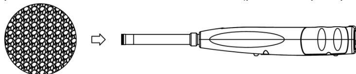
Appuyez fermement la bonnette anti-vent sur le microphone jusqu'à la butée, comme le montre l'illustration ci-dessus. De plus amples détails sur les corrections des pare-brise extérieurs figurent à l'[annexe 4](#).
