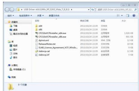
Décompressez et installez le pilote étape par étape. Sélectionnez X86 pour un système d'exploitation 32 bits et X64 pour un système d'exploitation 64 bits.
