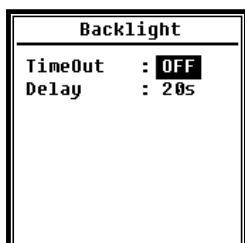
Le sonomètre éteint automatiquement le rétroéclairage pour réduire la consommation d'énergie et préserver la durée de vie des piles.
