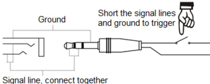
La mesure est lancée en connectant la ligne de signal à la masse et arrêtée en la déconnectant. Notez que lorsque la **fonction de déclenchement** est activée, le **bouton <Démarrage/Stop> n'est pas** disponible.
