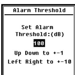
Lorsque les résultats de mesure des profils 1 à 3 dépassent le **seuil d'alarme**, la LED au-dessus de <Power> s'allume en rouge. Le seuil d'alarme peut être réglé entre 20 dB et 200 dB. Utilisez les touches fléchées <▲>, <▼> pour augmenter ou diminuer le seuil d'alarme de 1 dB. Utilisez les touches fléchées <◀>, <▶> pour augmenter ou diminuer le réglage de 10 dB.
