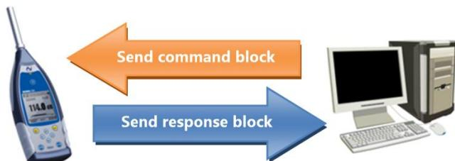
Un bloc de commande ou de réponse typique se compose d'un caractère de début, d'un ID, d'un caractère d'attribut, d'une commande ou de données, d'un caractère de fin, d'un caractère de vérification de bloc, d'un retour à la ligne et d'un retour chariot, conformément à la figure suivante :
