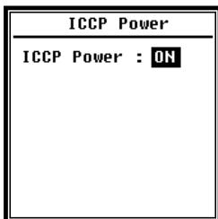
Le menu ICCP contrôle l'alimentation de tous les capteurs ICCP via la source de courant constant de 24 V/4 mA. Désactiver l'alimentation de l'ICCP avant de connecter un autre capteur ou de se connecter directement à la source du signal. Appuyez sur les touches fléchées <◀>, <▶> pour sélectionner.
