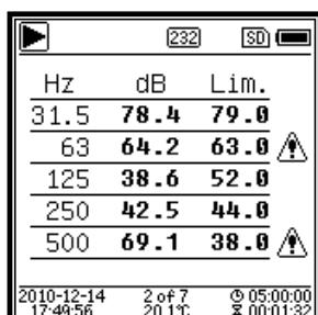
Tableau d'octave page 1. Affichage des données de mesure de 31,5 Hz à 500 Hz. La LED s'allume en rouge et apparaît, lorsque les données dépassent le seuil.
