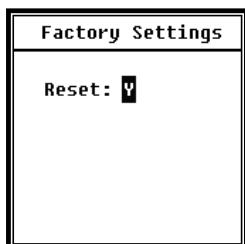
Les **paramètres d'usine** offrent la possibilité de réinitialiser tous les paramètres qui ont été modifiés par les utilisateurs aux paramètres d'usine. Les paramètres sont initialisés avec les valeurs par défaut. Utilisez les touches fléchées <◀>, <▶> pour sélectionner Y (Oui) ou N (Non). Si vous sélectionnez **Y** (Oui) et appuyez sur la touche <Enter>, le paramètre est initialisé. Si vous sélectionnez **N** (Non) ou appuyez sur la touche **ESC**, la réinitialisation est annulée.
