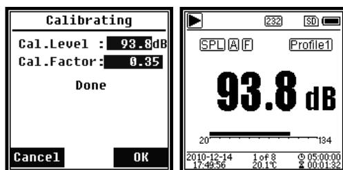
6. Revenez à l'écran principal et appuyez sur <Départ/Stop> pour commencer la mesure. Le résultat de la mesure actuelle dans cet exemple est de 93,8 dB si le calibrateur est en bon état de marche.
