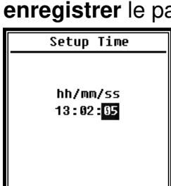
La modification du réglage de l'heure est similaire. Utilisez les touches fléchées **<◀>, <▶>** pour sélectionner l'heure, les minutes et les secondes et utilisez les touches fléchées **<▲>, <▼>** pour modifier la valeur. Appuyez sur **<Enter>** pour enregistrer le paramètre.
