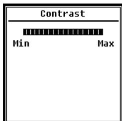
Le menu **Contraste** vous permet de régler le contraste de l'écran LCD sur 14 niveaux. Appuyez sur les touches **fléchées <▲>**, **<▼>** pour sélectionner.
