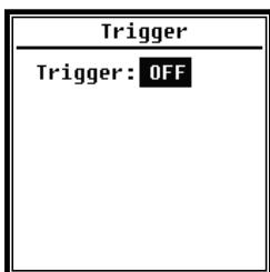
Dans le menu **Déclenchement**, vous pouvez activer et désactiver la fonction de déclenchement. Le **déclencheur** est une entrée analogique avec laquelle vous pouvez démarrer ou arrêter à distance la mesure du sonomètre. L'entrée de déclenchement est située sur la partie inférieure du sonomètre (prise casque 3,5 mm).
