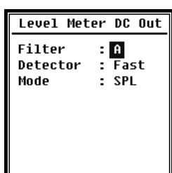
La **sortie CC** de l'indicateur de niveau peut définir la sortie du signal pour le mode indicateur de niveau. Appuyez sur les touches fléchées <▲>, <▼>, <>, <>> pour sélectionner.
