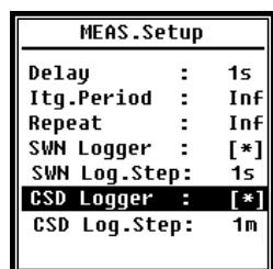
Le menu **MEAS.Setup** (Configuration de la mesure) est le menu le plus important pour la mesure. Ici, vous pouvez définir les paramètres pour le **délai**, la **période d'intégration**, la **répétition**, l'**étape du protocole SW**, l'**étape du protocole SWN**, le protocole **CSD** et l'**étape du protocole CSD**. Vous pouvez sélectionner les options à l'aide des touches fléchées <▲>, <▼>.
