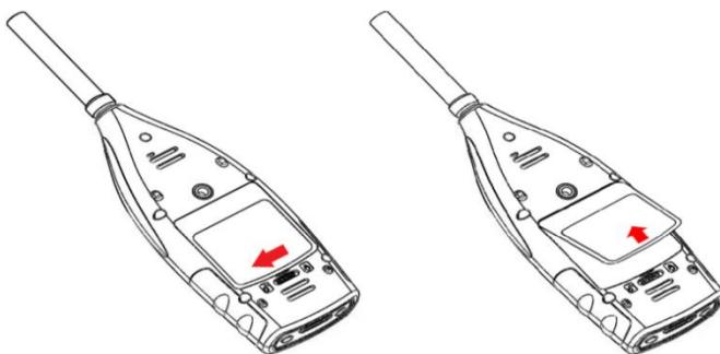
Tournez le loquet vers la gauche pour retirer le couvercle de la batterie. Soulevez le couvercle de la batterie.
