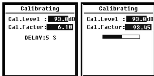
5. Lorsque l'étalonnage est terminé, le sonomètre met à jour le facteur d'étalonnage. Appuyez sur la touche <Enter> pour accepter les résultats.
