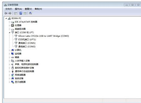
Après avoir installé le pilote, connectez le sonomètre à l'ordinateur à l'aide d'un câble USB. Dans le gestionnaire de périphériques, vous trouverez un nouveau périphérique nommé **Silicon Labs CP210x USB to UART Bridge (COMx)**.
