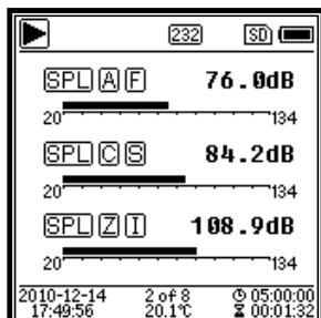
3 profils Affichage simultané des données et du mode de mesure correspondant du filtre et du détecteur de la mesure du profil. Les données des 3 profils peuvent être stockées dans un fichier SWN.
