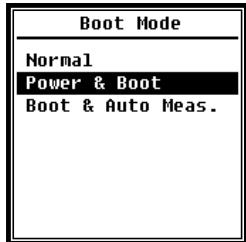
En **mode de démarrage**, utilisez les touches fléchées <▲>, <▼> pour sélectionner Normal, Alimentation et amorçage (**mise sous tension et démarrage**), ou Amorçage et mesure automatique. (Mise sous tension et mesure automatique).
