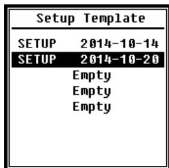
Utilisez le modèle de configuration pour stocker cinq paramètres de réglage de groupe d'utilisateurs du sonomètre pour différentes applications.
