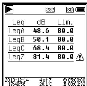
Page du tableau d'octave 3. Affichage des données de mesure de LAeqLBeq, LCeq ainsi que LZeq. La LED s'allume en rouge et apparaît lorsque les données dépassent le seuil.
