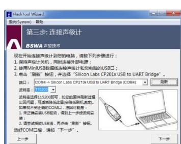
**Étape 3** : Connectez le sonomètre et l'ordinateur en suivant les instructions de l'utilisateur. Notez que le sonomètre nécessite une alimentation électrique externe. Si le pilote fonctionne correctement, il sélectionnera automatiquement le port CP210x. La **vitesse de transmission** par défaut est de 115200 bps, selon l'ordinateur. Un **débit en bauds** plus élevé accélérera la procédure de mise à jour.
