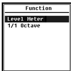
Sélectionnez la **fondction** et appuyez sur <Enter> pour entrer dans ce menu. Vous pouvez sélectionner 2 types de mesure: **Mesure du niveau** et **mesure 1/1 Octave**. Appuyez sur les touches fléchées <▲>, <▼> pour sélectionner le mode de mesure. Appuyez sur le **bouton <Enter> pour enregistrer** le paramètre et revenir au menu précédent. Appuyez sur la **touche <ESC> pour revenir** au menu précédent.
