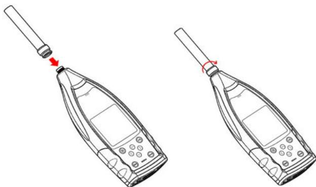
Connectez le microphone au connecteur TNC. Tournez ensuite le fil jusqu'à ce que les pièces soient fermement reliées.
