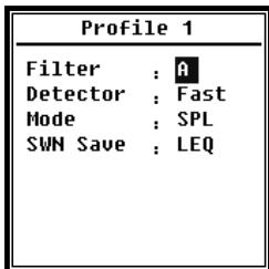
Le menu des profils 1 - 3 permet de définir le filtre, le détecteur, le mode ainsi que les options de stockage des fichiers SWN. Les options peuvent être sélectionnées avec les touches fléchées <▲>, <▼>.
