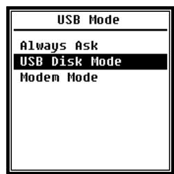
Le menu **Mode USB** vous permet de définir le mode de travail lorsque le sonomètre est connecté à l'ordinateur via un câble USB. Il est possible de sélectionner le mode **Toujours demander**, le mode **Disque USB** et le mode **Modem**.
