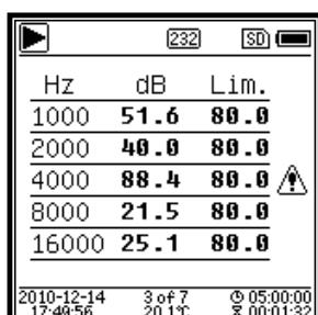
Tableau d'octave page 2. Affichage des données de mesure de 1 kHz - 16 kHz. La LED s'allume en rouge et apparaît, lorsque les données dépassent le seuil.
