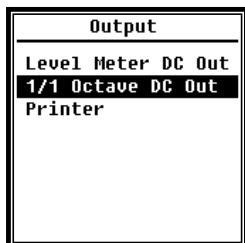
Dans le menu **Sortie**, vous pouvez sélectionner les données de mesure à sortir de la **sortie CC**. Pour le **mode de mesure du niveau** et le **mode 1/1 octave**, il existe des options de sortie CC de mesure du niveau et de sortie CC 1/1 octave.
