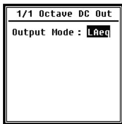
**1/1 Octave DC Out** définit le signal de sortie en mode 1/1 octave. Les options suivantes sont disponibles : LAeq, LBeq, LCeq, LZeq, 31,5 Hz, 63 Hz, 125 Hz, 250 Hz, 500 Hz, 1 kHz, 2 kHz, 4 kHz, 8 kHz, 16 kHz. Appuyez sur les touches fléchées <◀>, <▶> pour sélectionner.
