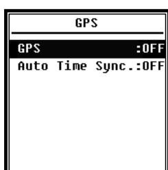
Dans le menu **GPS**, vous pouvez activer ou désactiver les options **GPS** et Synchronisation horaire **automatique**. Lorsque le **GPS** est désactivé, le module GPS interne est désactivé. L'horloge système du sonomètre se synchronise avec l'heure GPS lorsque vous activez l'option **Auto Time Sync**.
