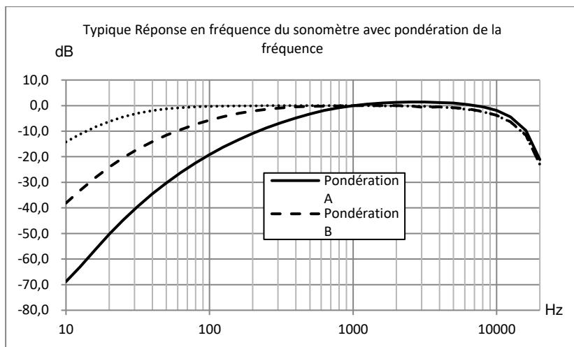
Le tableau suivant montre l'influence de la limite supérieure de la plage de mesure avec la pondération A, B et C et une réponse en fréquence typique comme indiqué sur la figure :
