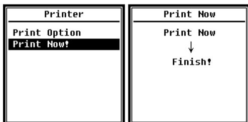
Si l'utilisateur sélectionne **Manuel**, il doit cliquer sur **Imprimer maintenant** et appuyer sur <Entrée> pour imprimer les données de mesure.
