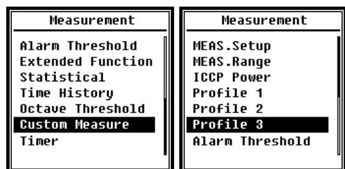
Il y a 13 options de menu dans le menu Mesure. Utilisez les touches fléchées <▲>, <▼> pour sélectionner les options et la touche <Enter> pour passer au menu suivant.
