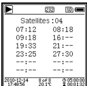
GPS Page 2. Affichage du nombre de satellites utilisés pour le positionnement et du rapport signal/bruit de tous les satellites visibles (0 dB - 99 dB).
