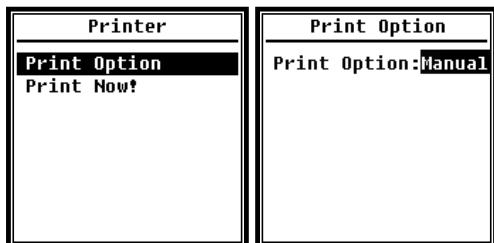
L'option **Imprimer** vous permet de configurer l'imprimante pour qu'elle imprime automatiquement ou manuellement. Si vous sélectionnez **Auto**, les résultats de la mesure sont imprimés automatiquement après l'arrêt de la mesure.
