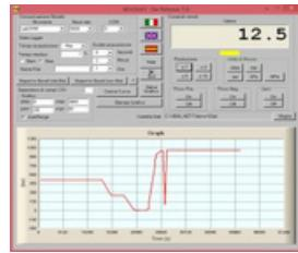
Quick Analyser Light : un logiciel professionnel qui s'interface directement au BTR2 et accompagne l'opérateur dans les différentes étapes de tests comme : l'analyse, le suivi dans le temps, le stockage des données,
